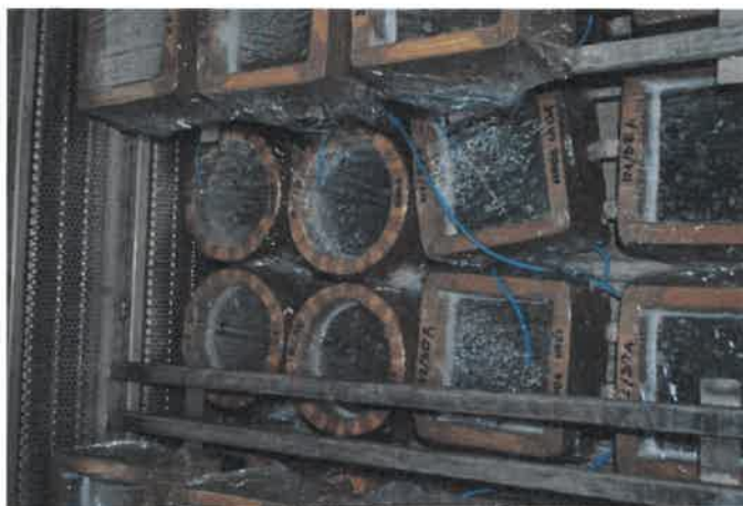
Rys. 3.3.2-3. Widok próbek podczas badań w komorze zamrażalniczej
