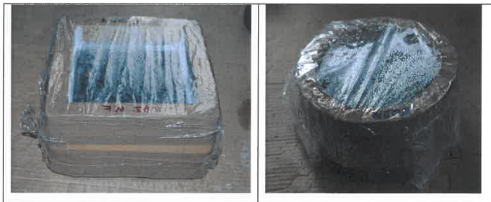
Rys. 3.3.2-2. Widok przykładowych gotowych próbek do badań odporności na powierzchniowe złuszczenie
