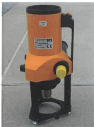
Rys. 3.4.1-1. Aparat pull-off firmy Josef Freudl
