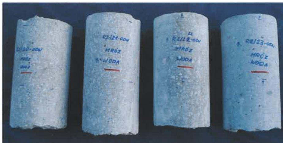
Rys. 3.3.1-2. Pobrane odwierty rdzeniowe, z których wykonano próbki przeznaczone do badań mrozoodporności w wodzie
