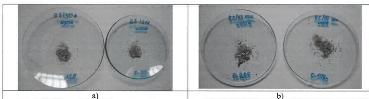
Rys. 3.3.2-5. Materiał złuszczoney zebrany z próbek wyciętych, a) z kostek 15x15x15 cm i b) z odwiertów rdzeniowych, po badaniach odporności na powierzchniowe złuszczenie w wodzie
