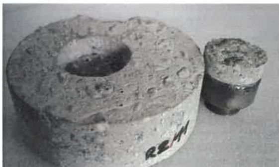
Rys. 3.4.2-1. Rodzaj zniszczenia podczas badań wytrzymałości na odrywanie warstwy powierzchniowej nawierzchni odcinka doświadczalnego (badania wykonane z wykorzystaniem odwiertów rdzeniowych. Zerwanie kohezyjne w betonie.
